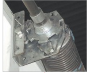
Yay Kırılma Emniyet Sistemi
